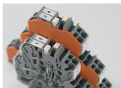
Die Vertikalbrücker für das TOPJOB®S-Reihenklemmenprogramm verbinden in Doppel- und Dreistockklemmen zwei beziehungsweise drei Ebenen miteinander. Ob es sich um einen Doppelstock-Vertikalbrücker (Bestellnr. 2002-492) oder einen Dreistock-Vertikalbrücker (Bestellnr. 2002-493) handelt, signalisieren die auch im gesteckten Zustand gut sichtbaren Ziffern „2“ und „3“.
