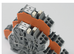
Die Vertikalbrücker für das TOPJOB®S-Reihenklemmenprogramm verbinden in Doppel- und Dreistockklemmen zwei beziehungsweise drei Ebenen miteinander. Ob es sich um einen Doppelstock-Vertikalbrücker (2002-492) oder einen Dreistock-Vertikalbrücker (2002-493) handelt, signalisieren die auch im gesteckten Zustand gut sichtbaren Ziffern „2“ und „3“.
